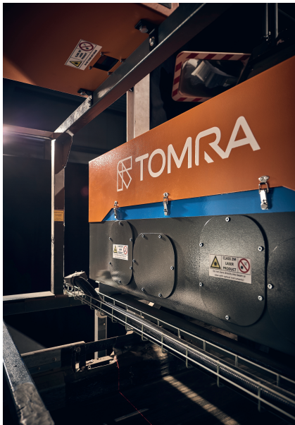
Bild 4. Deep Learning im Einsatz: Für seine Autosort-Sortiermaschinen bietet Tomra das neuronale Netz Gain an. Mit diesem können etwa Silikonkartuschen aussortiert werden
