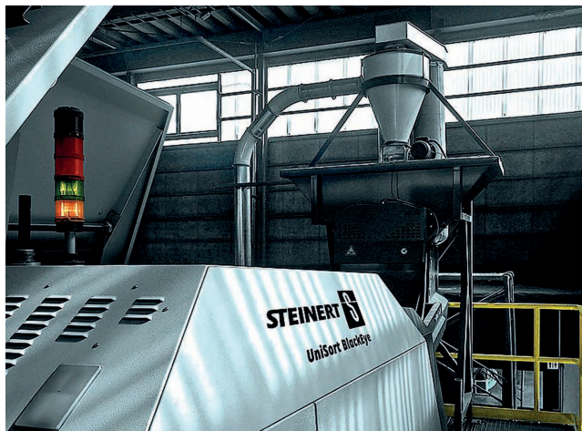
Bild 3. Das Sortiersystem UniSort Blackeye von Steinert kann auch mit Ruß eingefärbte schwarze Kunststoffabfälle sortieren © Steinert
